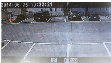
※ 4mの高さからの撮影範囲画像。 7インチ液晶モニター（オプション）にて確認、調整。
